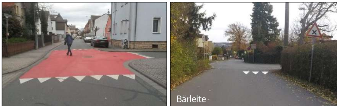
Abb. 44 Beispiel / Fotomontag zur Markierung von „Haifischzähnen“
