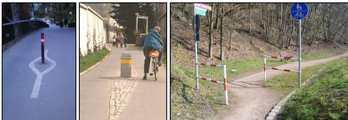
Abb. 55 Beispiele für die Reduzierung von Konfliktpotenzialen an Pollern / Umlaufsperrren
