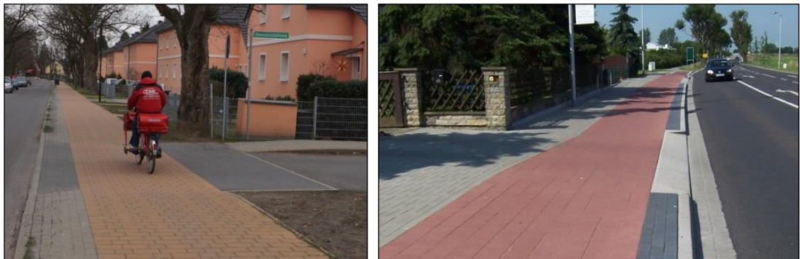
Abb. 46 Beispiele für Gehwegüberfahrten bzw. radfreundliche Ein- und Ausfahrten
