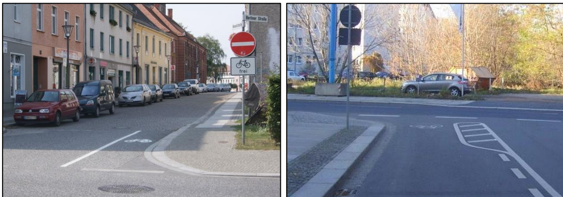
Abb. 43 Einfahrhilfen im Einmündungsbereich freigegebener Einbahnstraßen
