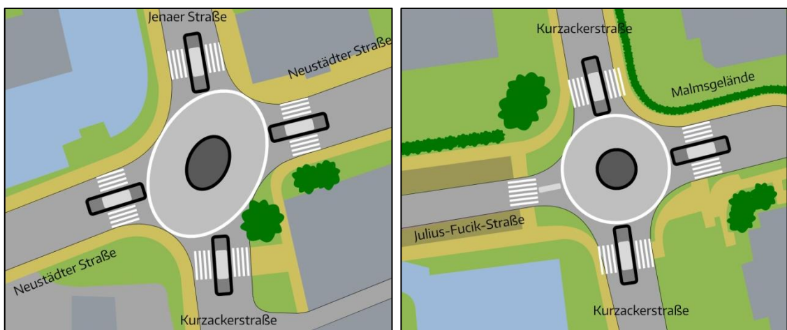
Abb. 49 Prinzipskizzen Umgestaltung zum Minikreisverkehr
